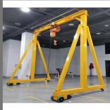
10 Ton Portal Gantry Crane
